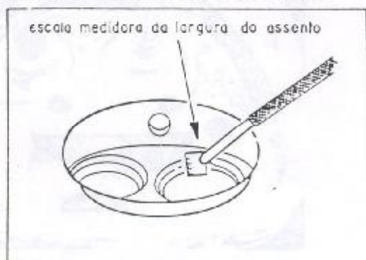
Figura 1.09.4 - Medição das sedes das válvulas
